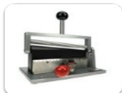
L'essai de pliage sur mandrin est utilisé pour **tester l'élasticité, l'adhésion et l'élongation de la peinture** sur un support métallique par observation des craquelures de peinture résultantes de la déformation.
