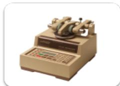
L'abrasimètre permet d'effectuer des essais d'usure accélérée sur une grande variété de matériaux. L'échantillon est fixé sur un plateau tournant horizontal, puis soumis à l'action de deux meules abrasives montées sur des bras articulés et appliquées avec une charge ajustable.
