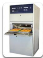
Cette enceinte permet de tester tout type d'échantillons à l'**effet du spectre solaire complet** tout en maîtrisant l'humidité et la pulvérisation d'eau.
