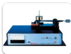
Test destiné aux essais de peintures, vernis et plastiques appliqués sur tous types de supports plans. L'échantillon est attaqué par un outil chargé d'un poids variable de 0 à 10kg. Un voltmètre et un voyant lumineux permettent de **détecter automatiquement, sur supports métalliques, la rupture du revêtement.**
