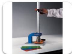
L'essai au choc tubulaire permet de déterminer la résistance au choc d'un revêtement appliqué sur un support, en étudiant la déformation provoquée par la chute d'une masse en acier sur une éprouvette revêtue.
