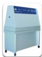
Cette enceinte permet de tester tout type d'échantillons à l'**effet des rayons UV** tout en maîtrisant l'humidité et la pulvérisation d'eau.
