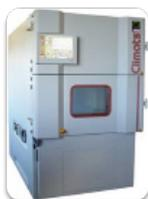
Cette enceinte permet de tester **tout type d'échantillons** à la tenue à un cycle de température ainsi qu'à l'humidité.
