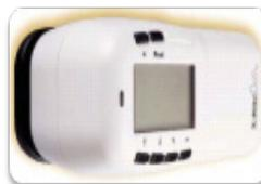
Cet équipement permet de qualifier et comparer les couleurs suivant les domaines colorimétriques normalisés dont les principaux sont:  $L^*a^*b^*$ ,  $L^*C^*h$ ,  $x y Y$  et  $XYZ$ .
