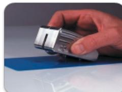
L'indentation Buchholz permet de tester la dureté superficielle des films de peinture et de vernis, en déposant sur le revêtement d'une roue biseautée sous une charge. La taille de l'empreinte détermine la dureté du revêtement.
