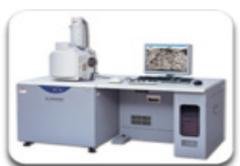
Une partie de l'éprouvette est enrobée afin de visualiser le revêtement en coupe. Une visualisation par microscopie électronique à balayage (MEB) permet de dimensionner le(s) couche(s) du revêtements de surface.
