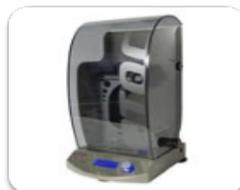
Le pendule de dureté s'appuie sur le principe selon lequel l'amplitude de l'oscillation d'un pendule reposant sur une surface diminue plus rapidement si cette surface est tendre.
