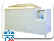
Ces enceintes permettent de créer un brouillard salin homogène afin d'**accélérer le vieillissement de plusieurs échantillons**. Les observations cycliques permettent de qualifier la tenue d'objets à une atmosphère salée.
