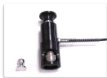
Il s'agit de mesurer la force requise pour arracher de son support une surface de revêtement par pression hydraulique. Cet équipement test l'**adhérence des revêtements en mesurant la force nécessaire à l'arrachement d'une pastille** de diamètre connu collée sur le revêtement à tester.
