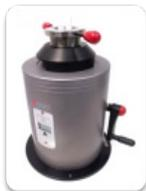
L'essai d'emboutissage permet de tester la résistivité des revêtements à la déformation par emboutissage.
